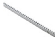
CREM-12 Verzinkt stalen tandheugel (M4|30x12mm), lengte: 1.000mm
