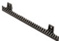
CREM-P Nylon tandheugel (M4) voor schuifpoorten tot 800Kg, lengte: 1.000mm
